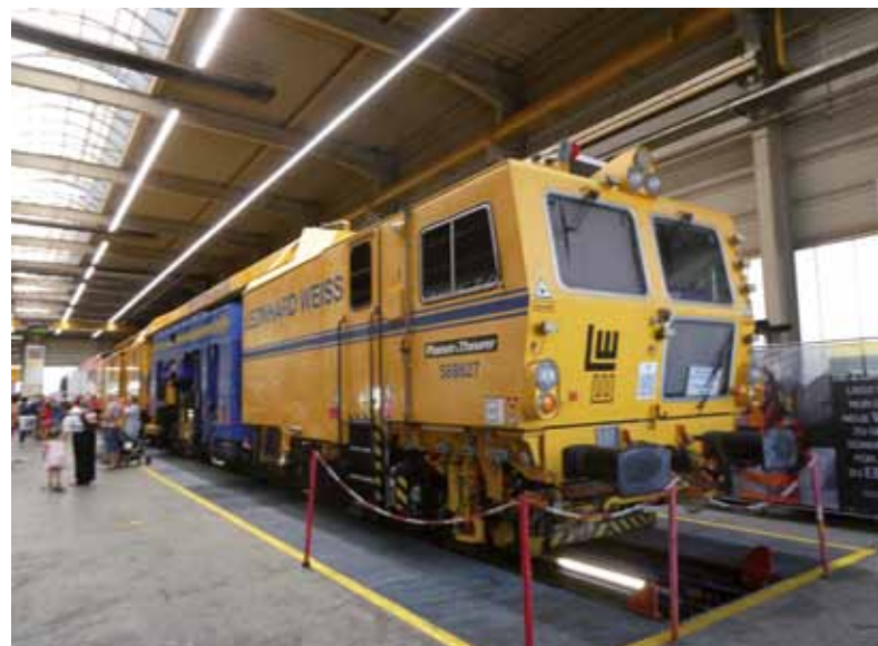
Gleisstopfmaschine Unimat bei Leonhard Weiss
