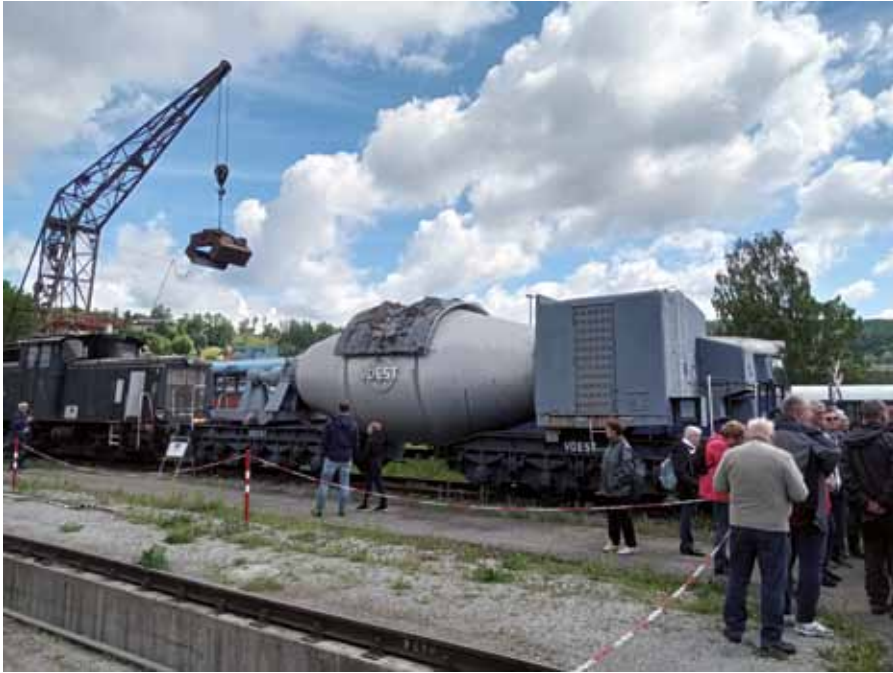
Torpedowagen „Pumuckl“ zum Transport flüssigen Roheisens
