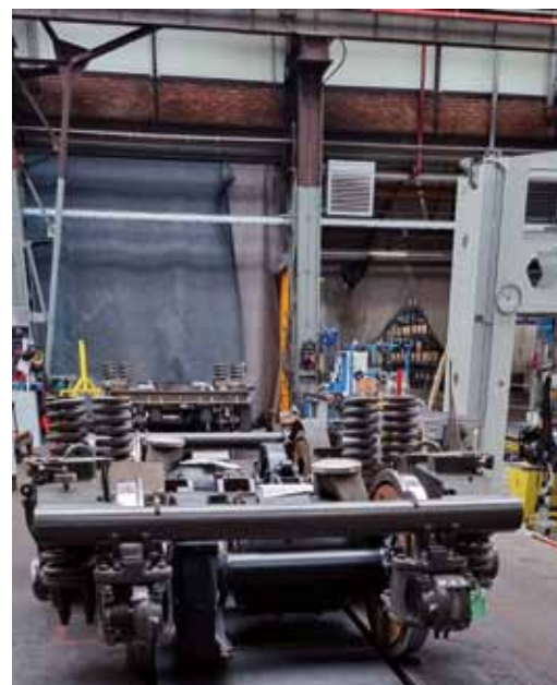
Eine der vielen Aufgaben der TS Linz ist die Aufarbeitung von Drehgestellen
