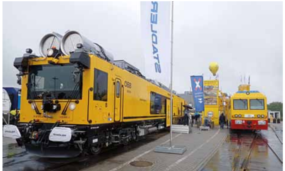
Ein von der ÖBB zur Tunnelrettung beschaffter Servicejet war ausgestellt
