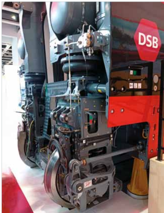
Blick auf das einachsige Laufwerksportal des Talgo ohne durchgehende Radsatzwelle
