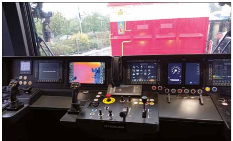
Die beiden Joysticks zum steuern der zwei Wasserkanonen li. im Bild
