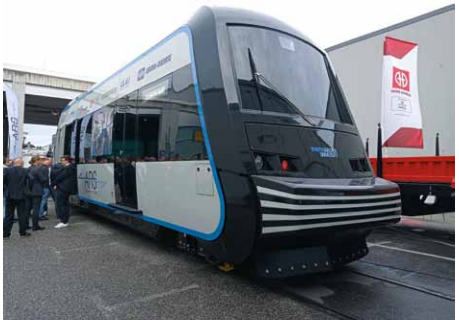
Das von der Technischen Hochschule in Aachen entwickelte Aachener Rail Shuttle (ARS), ein leichtes 2-achsiges batterieelektrisches Fahrzeug
