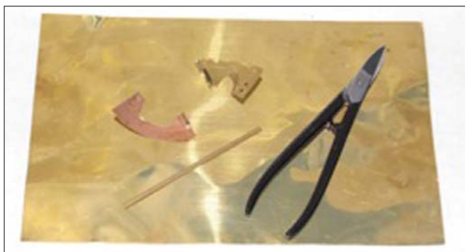
Bild 4 Messingblech ist für bewegliche Module unentbehrlich. Mit einer kleinen Blechschere lassen sich komplizierte Teile wie die Mitnehmerwinkel der Drachenscheibe ausschneiden. Messing federt immer in die eingestellte Biegung zurück.
