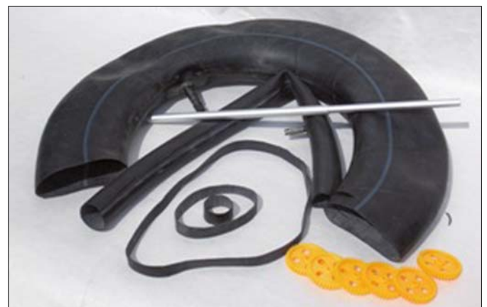
Bild 2 Zwei ineinandergeschobene Alustäbe dienen als Achsen. Reifenabschnitte sind die ideale Transmission, mit der sie auch im Dauerbetrieb keine Probleme haben. Die gelben Plastikzahnräder haben wir preiswert bei Conrad gefunden. Sie sind nötig, wenn eine Drehung absolut synchron übertragen werden soll.
