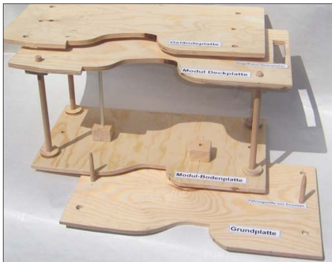
Bild 1 Die Drachenhöhle findet Platz in einem Gestell. Deutlich sind die Bohrungen für die Dübelstäbe zu sehen. Zwei zusätzliche, angespitzte Führungsstifte sollen das Einsetzen des Moduls in die Grundplatte erleichtern. Die Moduldeckplatte hat Eingriffe zum Herausheben
